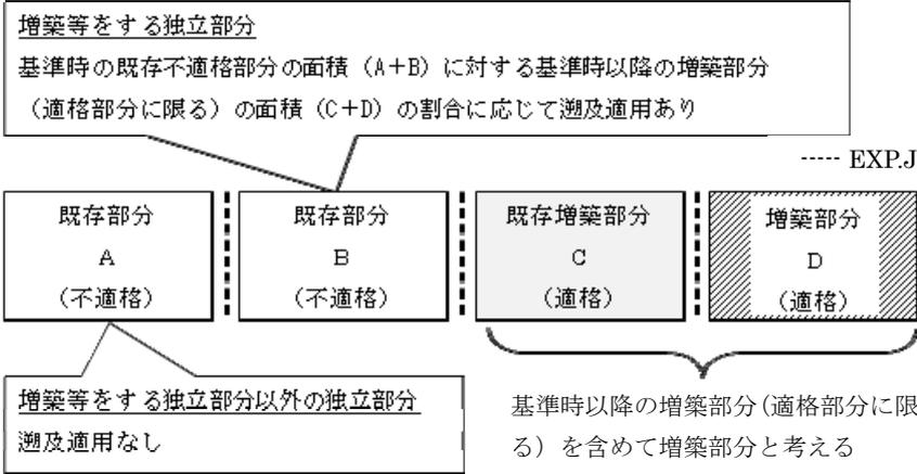
※既存不適格建築物(A+B)に対してCを増築(現行法適格)した既存建築物にDを増築する。
